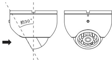
本製品を設置の際は、カメラ部分を約30°以上(90°以内)傾け、正面から見たときにカメラ部分全体が見えるようにしてください。
