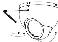
5. 付属の六角レンチ(中)でカメラ部角度調整ネジをゆるめるとカメラ部の方向・角度が調整できます。
