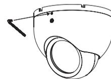
4. 付属の六角レンチ(小)で取付ベース固定ネジを締め、本体と取付ベースを固定します。
