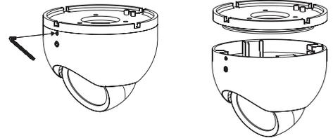
1. 付属の六角レンチ(小)で取付ベース固定ネジをゆるめ、取付ベースを本体からはずします。
